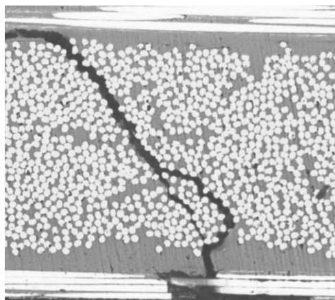
Figura 1-1. Micrografía en la que se observa la grieta a 45^\circ que aparece en la capa de 90^\circ .
