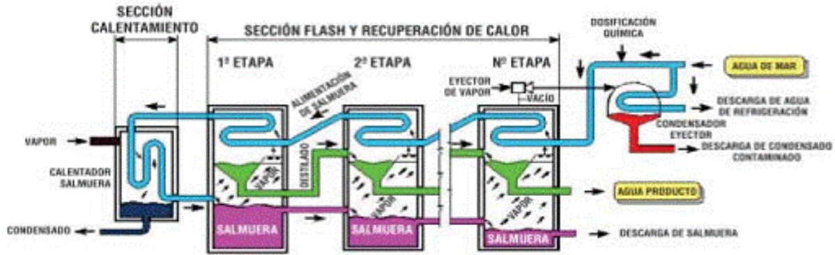
Figura 5-7: Esquema del proceso de destilación flas (47).
