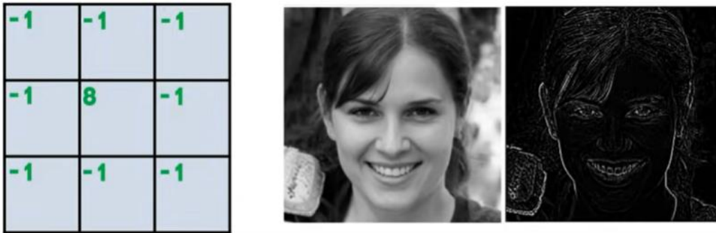
Figura 21: Ejemplo de filtro utilizado para localizar bordes en una imagen [20]
