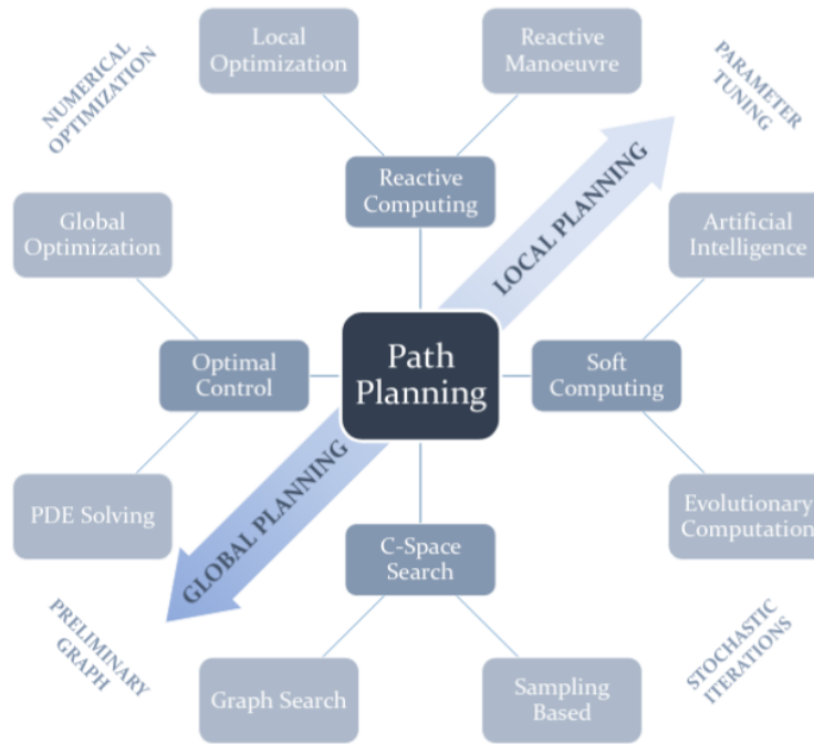
Figura 2.1 Esquema de los distintos enfoques existentes en la actualidad al problema de "Path planning" [17].
