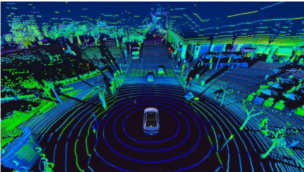
**Figura 2.2** Construcción de un mapa utilizando sensores LiDAR.
