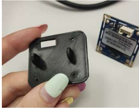
Figura 3.19 Adaptador para sujetar la cámara al Jetbot.
