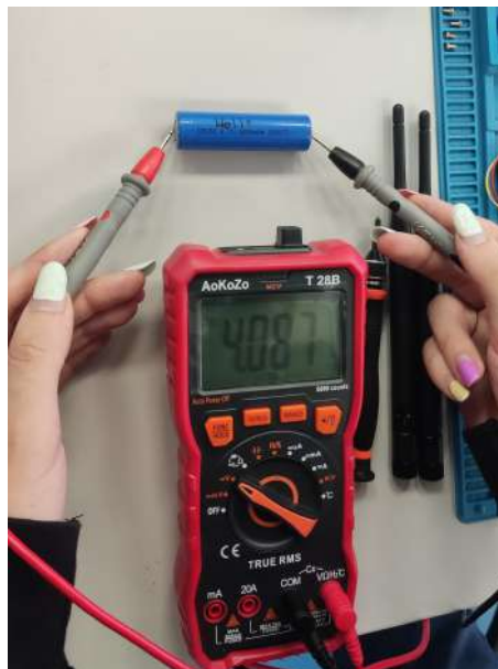
Figura 3.11 Medida de tensión de baterías.
