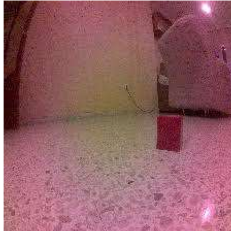
Figura 3.16 Ejemplo de la distorsión radial en la cámara original.
