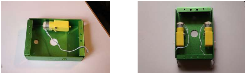
Figura 3.3 Montaje de los motores en el chasis.
