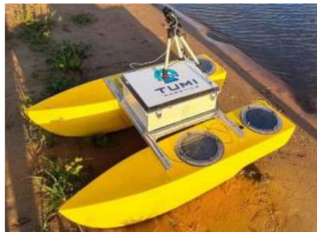
Figura 1.1 Vehículo autónomo usado para la supervisión del lago Ypacarai.
