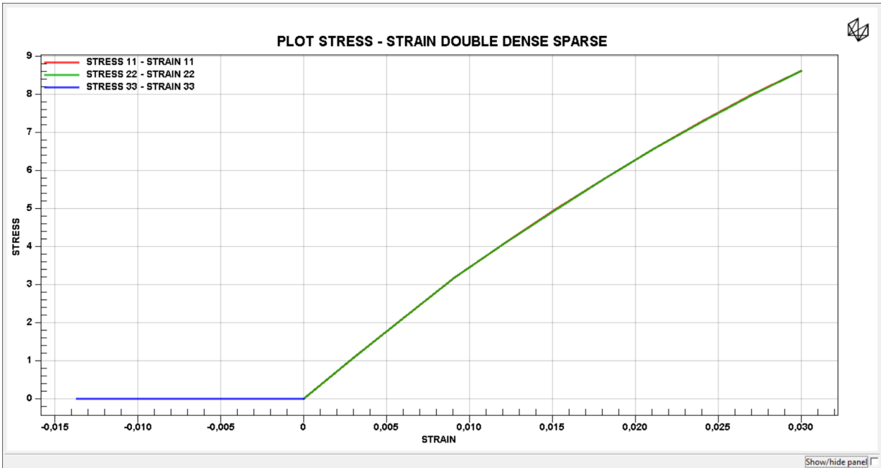
Figura 3.26 Gráfica de resultados de la Simulación 2 DOUBLE DENSE SPARSE FE
