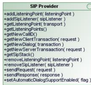
Figura 9. Diagrama de clase de SIP Provider
