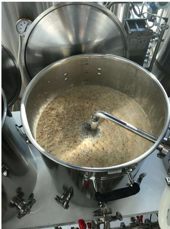
Imagen 65. Llenado del tanque MT poco homogéneo.
