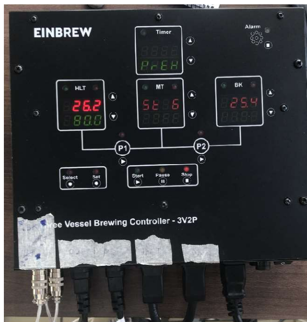
Imagen 34. Controlador EINBREW en el modo PrEH.
