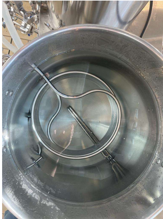
Imagen 39. Tanque MT lleno de agua para mantenimiento isoterma de HLT.
