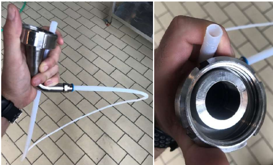
Imagen 54. Acople DN25 a tubing 3/8" necesario para el relleno de botellines manual.
