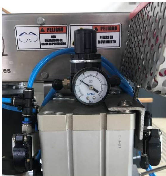
Imagen 55. Detalle de los botones y manómetro de la máquina tapadora.
