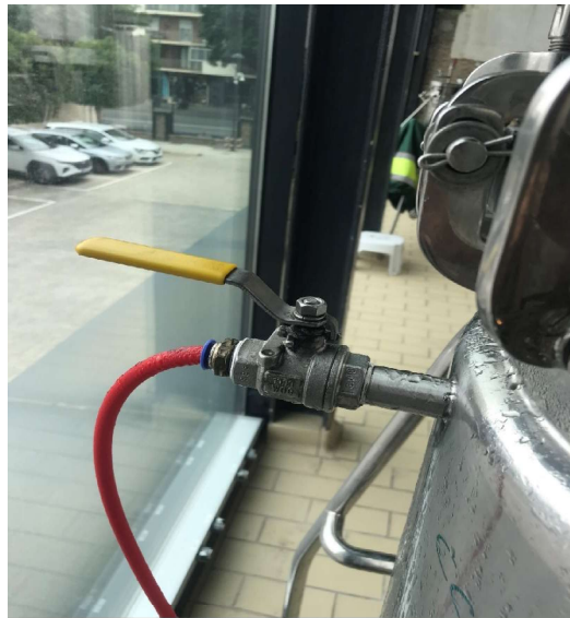
Imagen 27. Salida de etilenglicol del fermentador.
