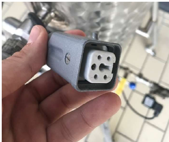
Imagen 25. Conexión de la electroválvula hacia el controlador del anillo temperatura de Factoría Cruzcampo.
