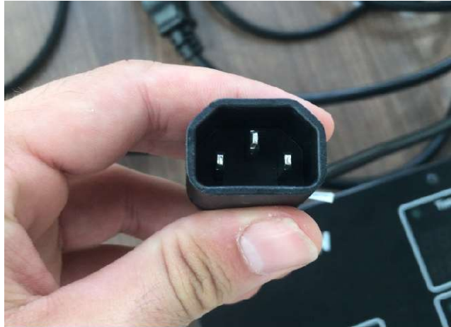
Imagen 20. Conexión del cable de alimentación eléctrica al controlador.
