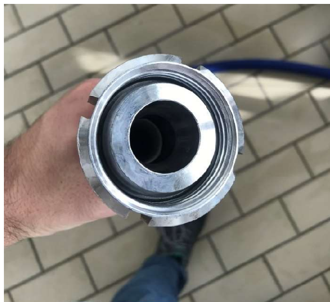
Imagen 22. Manguera de conexión DN25 hacia la pieza macho-macho.
