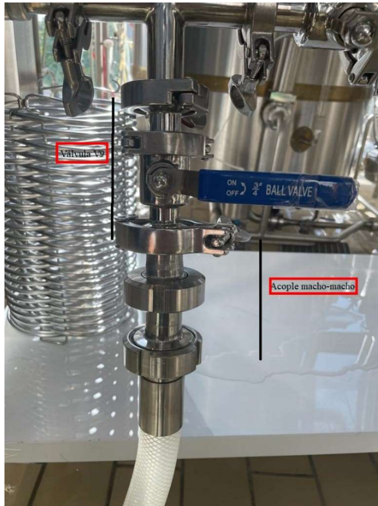
Imagen 21. Pieza macho-macho DN25 saliente de la válvula V9.
