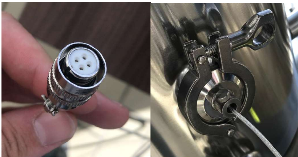
Imágenes 17 y 18. Conexiones de las sondas 3PT100 de temperatura al controlador y ollas.
