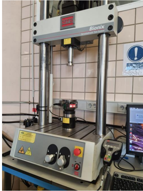
Figura 3-11. Prensa hidráulica con célula de carga de 5 kN
