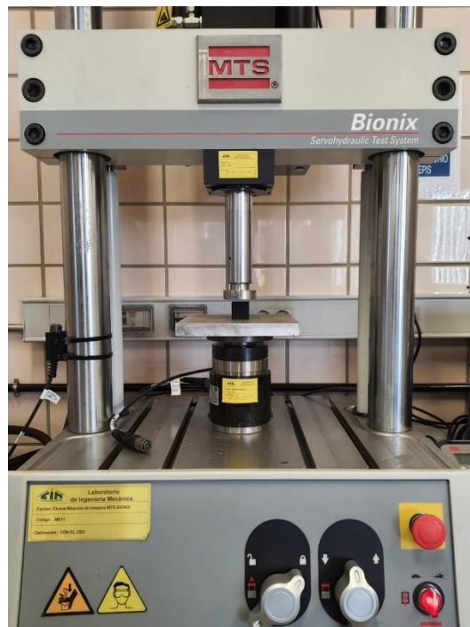
Figura 3-12. Probeta preparada para ensayo sobre la base con la célula de 15 kN
