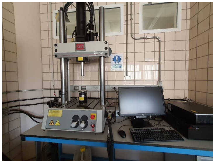
Figura 3-10. Prensa hidráulica junto con el equipo desde el que se controla
