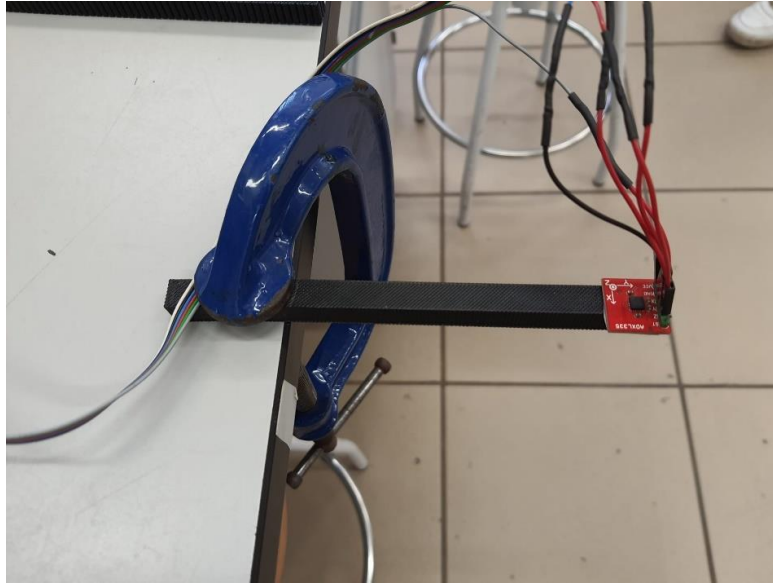
Figura 3-17. Viga del 100 % de infill preparada para el ensayo
