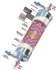
Figura 4. Eliminación del O_2 en el agua.
