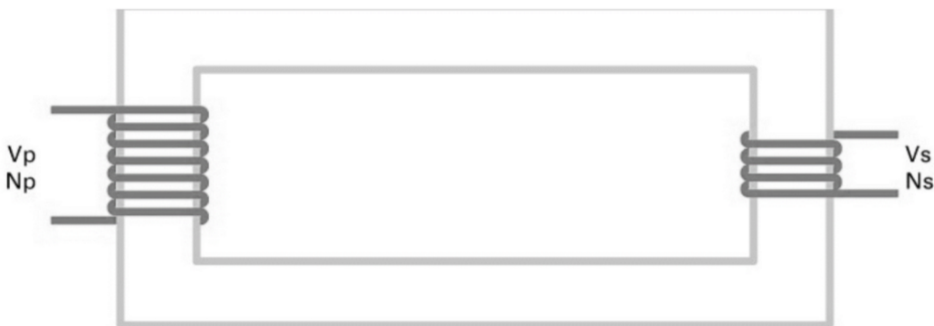
Figura 4 - Transformador eléctrico reductor
