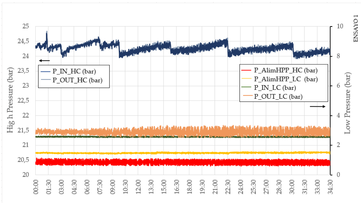
Figura 33. Evolución de la presión a lo largo del ensayo 1 en los siguientes puntos. Para la corriente de alta presión; P_{AlímHPP\_HC} , alimentación de la bomba HPP. P_{IN\_HC} y P_{OUT\_HC} , entrada y salida de la membrana respectivamente. Para la corriente de baja presión.
