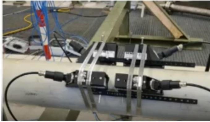
**Figura 2.11** Tubería de transporte de hidrógeno con caudalímetro no invasivo[1].
