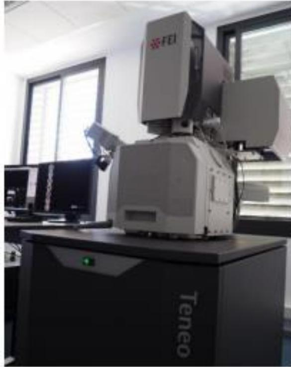
Figura 3-10 Microscopio electrónico de barrido SEM FEI Teneo.
