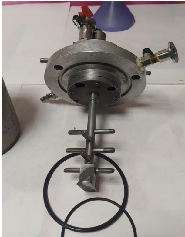
Figura 3-19 Tapadera con brazo rotatorio.
