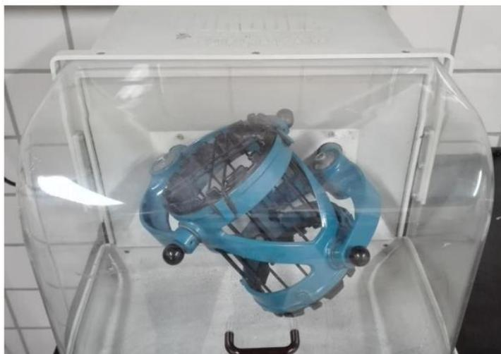
Figura 3-1 Molino mezclador TURBULA TYPE T2 C
