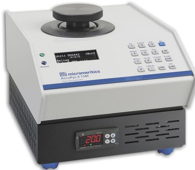
Figura 3-6 Picnómetro Accupyc II 1340
