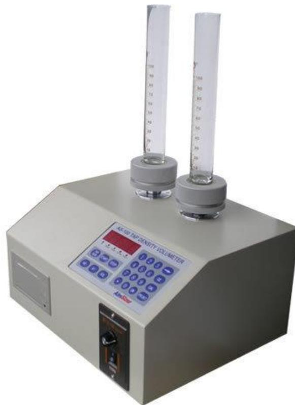
Figura 3-5 Medidor de densidad de golpeo
