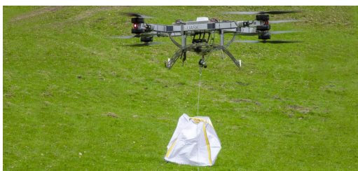
(c) Transporte de carga y aterrizaje en plataforma [3].
