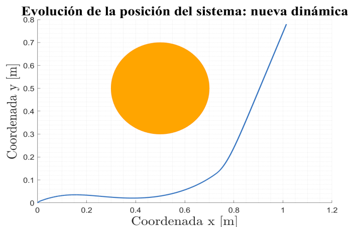
Figura 5.15 El sistema evita el obstáculo correctamente.
