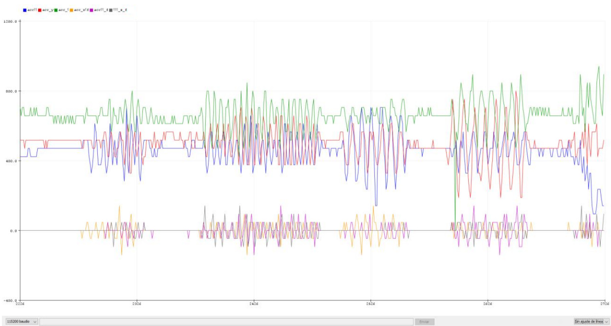
Figura 7-2. Gráfica de aceleraciones en bruto (x: azul, y: rojo, z: verde) y aceleraciones tras aplicar el filtro supresor de continua (xf: naranja, yf: violeta, zf: gris), generadas en tiempo real en la herramienta Arduino IDE Serial Plotter.
