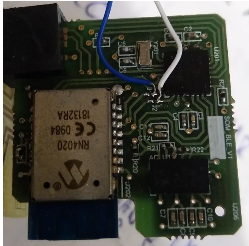
Figura 5-3. Cables soldados a los jumpers J1 y J2 para establecer conexión con los pines TX y RX del MCU.
