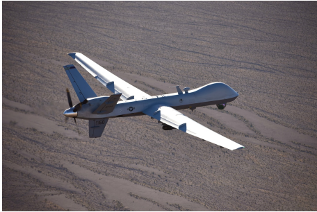
(a) MQ-9 Reaper, UAV de ala fija del ejército de EEUU [15].
