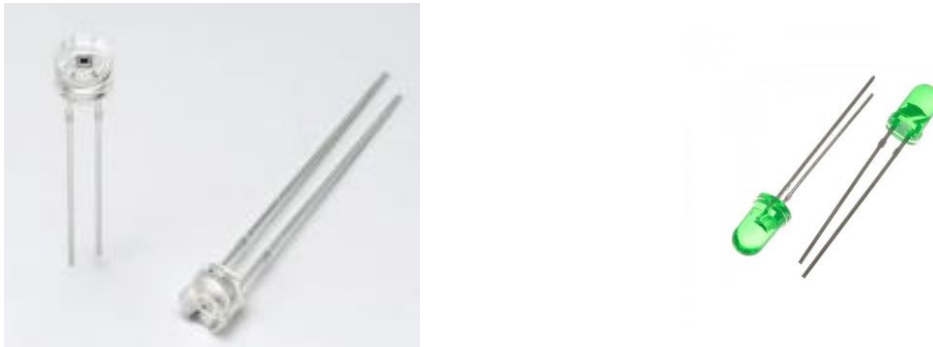
Figura 4-4 Conjunto de componentes del sistema de detección óptico, a la izquierda los fotodiodos y a la derecha los LEDs.
