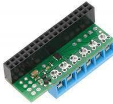
Figura 5. Kit de desarrollo suministrado por la compañía Pololu basado en el driver DRV8835.[3]
