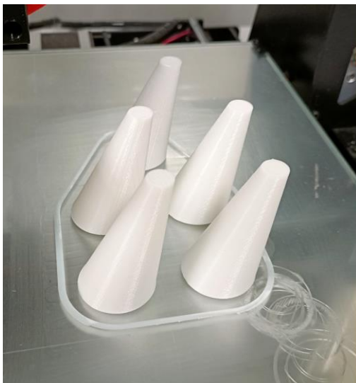
Figure 45 Cono truncado inclinado: foto impresión (Izq.), modelo Repetier Host (Der.)
