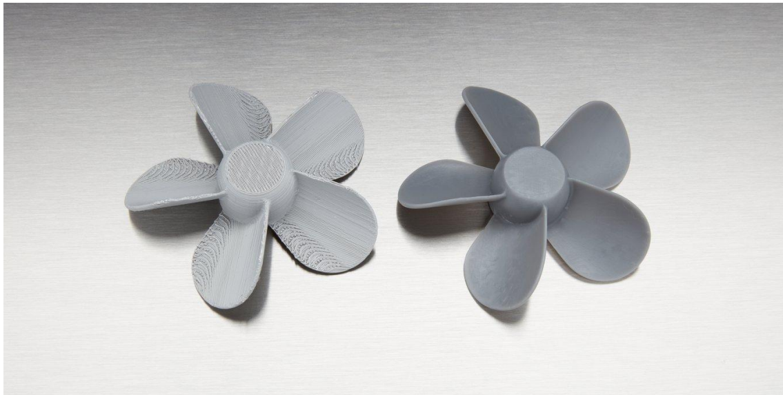
Figure 4 Pieza impresa con FDM (Izq.) y con SLA (Der.) [14]
