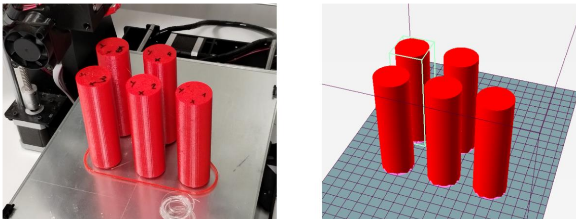
Figure 38 Cilindro recto: foto impresión (Izq.), modelo Repetier Host (Der.)
