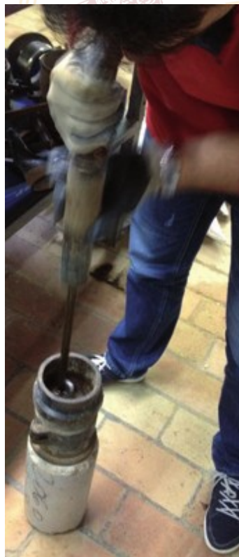
Figura 10. Ensayos de caracterización física de suelos realizados en los laboratorios de ETSIE y ETSA, Universidad de Sevilla. Fila superior: Granulometría. Central: Límite líquido con cuchara de Casagrande. Inferior: Densificación, método Proctor.
