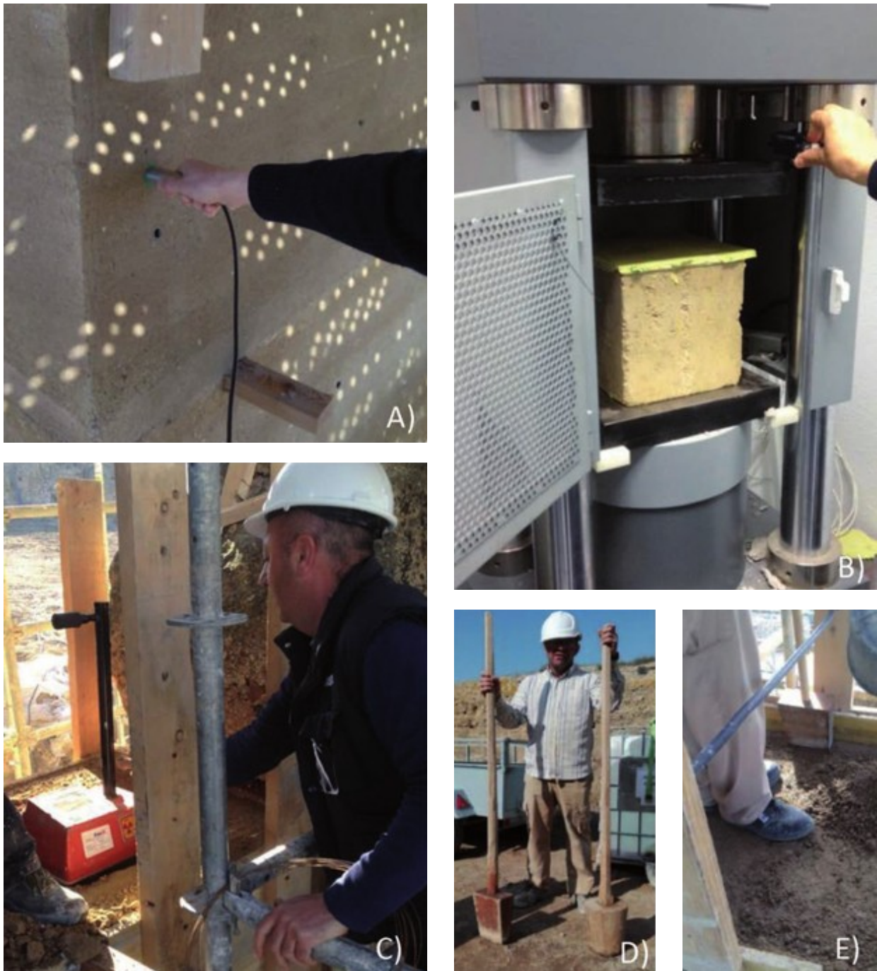
Figura 19. Ensayo de velocidad de ultrasonidos (A). Ensayo de resistencia a compresión simple (B). Ensayo nuclear o CPN (C). Control de la compactación manual (D, E)
