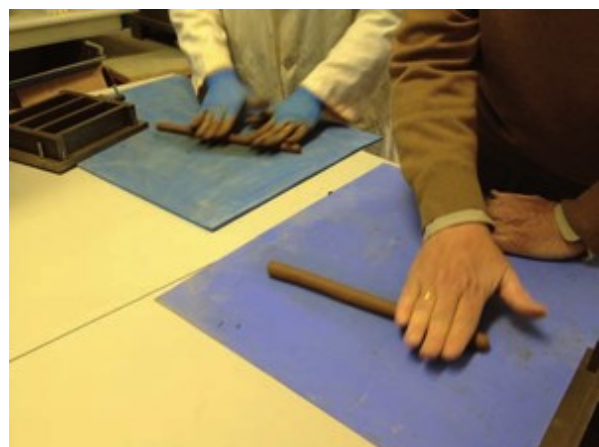
Figura 9. Preparación y amasado de muestras de suelos con diferentes dosificaciones de agua evaluando su exudación. Central: Prueba de la cinta y medición de muestra en zona de corte. Inferior: prueba del rollo
