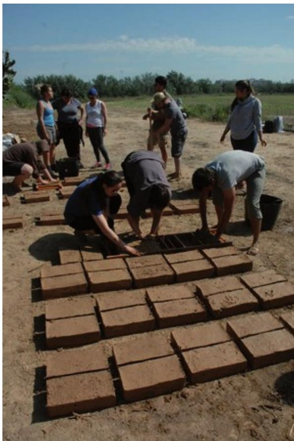
Figura 7. Proceso de fabricación de adobes y secado al sol (Fot. O. Rodríguez)
