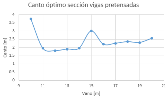
Gráfica 2. Cantos óptimos puentes de vigas pretensadas
