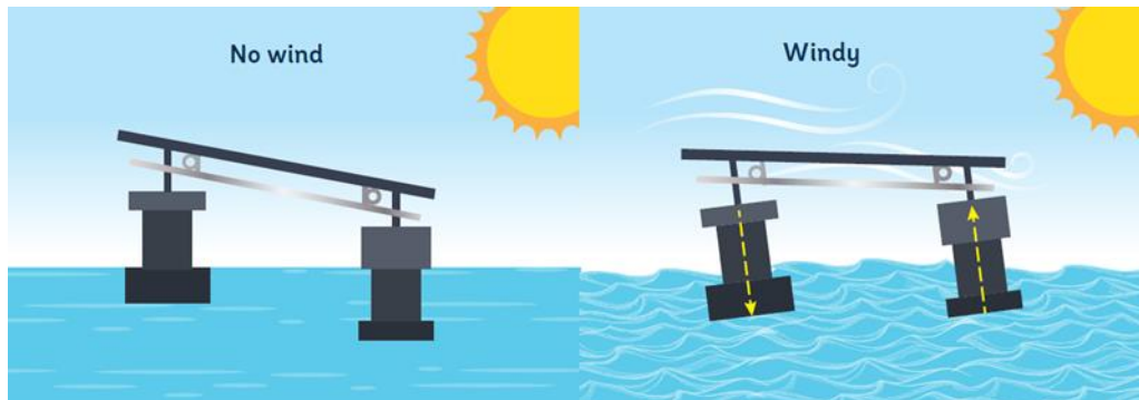
Figura 2-11: Esquema del sistema de flotación de Solaris Synergy. [14]
