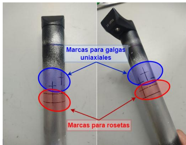
Figura 4.1-4. Tija del sillín después del lijado y marcas guía.
