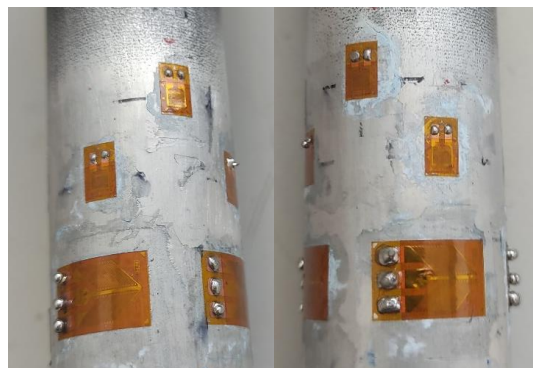
Figura 4.1-14. Galgas extensométricas tras el proceso completo de adhesión.
