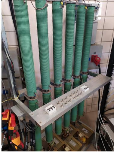
Figura 3.5 Carga  $RL$  del Laboratorio.
