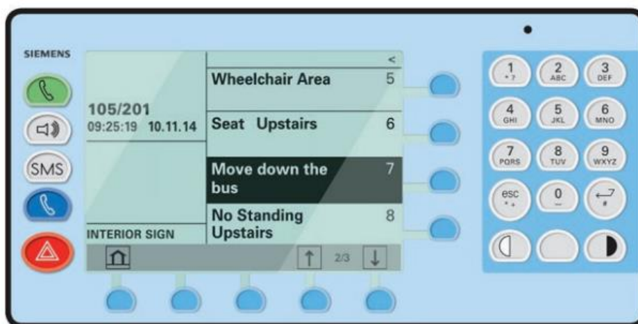
Figura 8. Interfaz de iBus para los conductores de autobuses, con diferentes avisos para los pasajeros.
