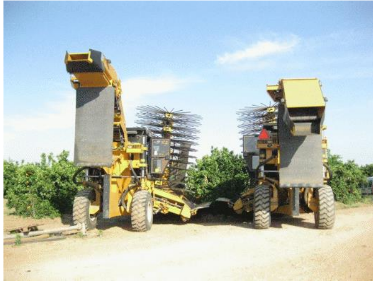
Fotografía 8. Sacudidores de copa autopropulsados con estructuras de recogida (OXBO 3220) trabajando de forma sincronizada ambos lados de la línea de plantación.
