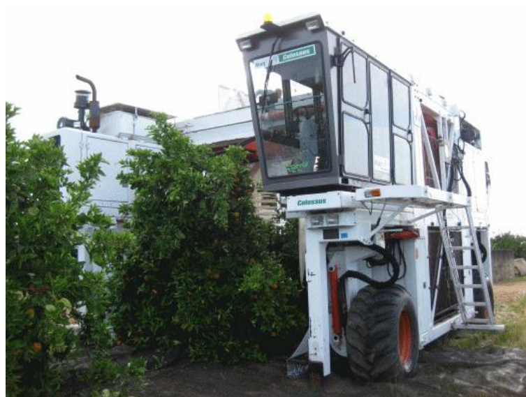
Fotografía 9. Sacudidor de copa cabalgante autopropulsada (Colossus). Fuente:
