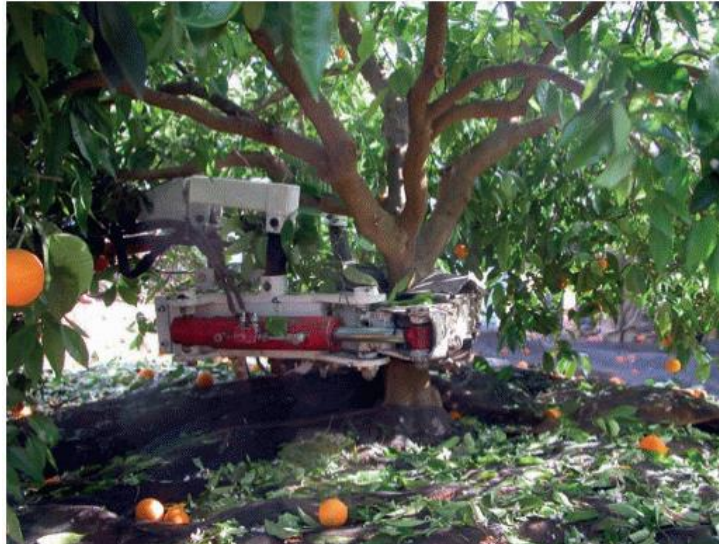
Fotografía 6. Equipo vibrador de tronco. Fuente: Chueca et al., 2020
