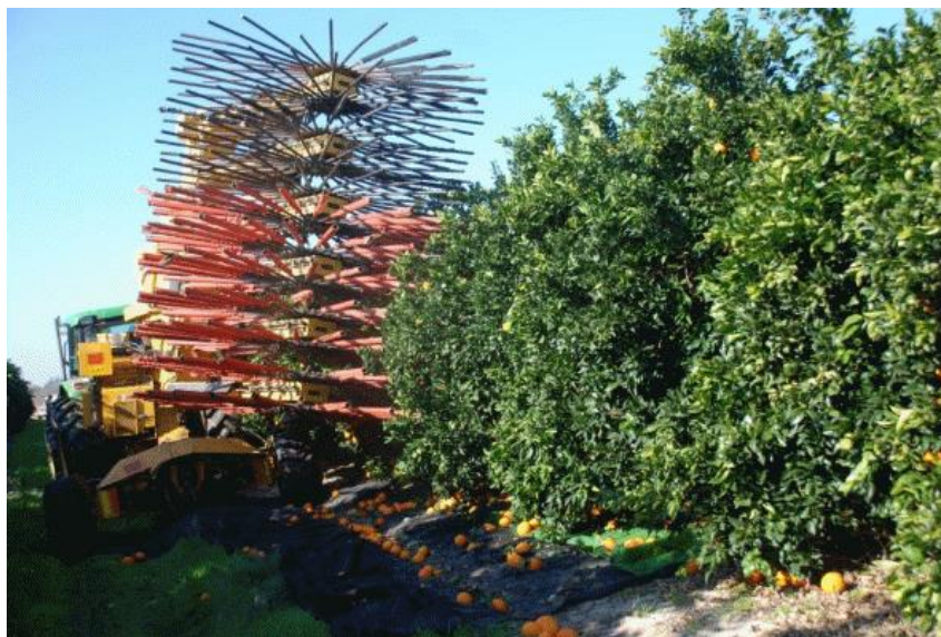
Fotografía 7. Equipo sacudidor de copa accionado y remolcado por tractor y con derribo de la fruta al suelo (OXBO 3210). Fuente: Departamento de Cítricos. IFAPA Las Torres
