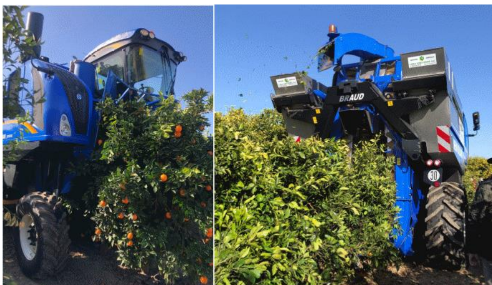
Fotografía 10. Equipo sacudidor de copa cabalgante `tipo vendimiadora´ (New Holland Braud 9090X): a) Detalle de los árboles antes del pase del equipo; b) Detalle de los árboles tras el pase del equipo. Fuente: Departamento de Cítricos. IFAPA Las Torres
