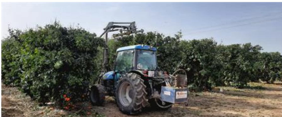
Fotografía 5. Detalle de la poda mecanizada en una plantación de cítricos en súper alta densidad. Fuente: Departamento de Cítricos. IFAPA Las Torres
