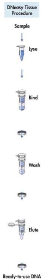
Figura 26. Esquema del procedimiento de extracción de ADN de acuerdo con el protocolo DNeasy ® Blood & Tissue Kit de QIAGEN.
