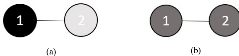
Figura 4.6. Grafo de dos nodos inicial (a) y grafo tras ser procesado en red GNN muy profunda (b).
