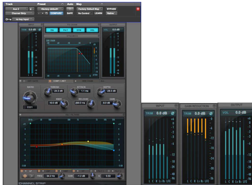
Figura 7. Complemento Channel Strip, con las secciones de entrada, reducción de ganancia y salidas.
