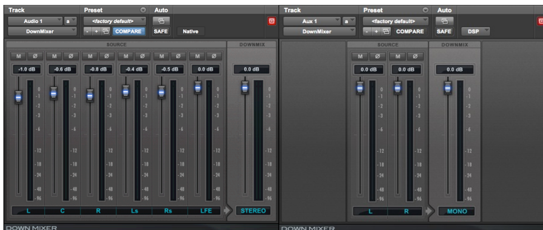
Figura 13. Complemento de mezcla Down Mixer de Pro Tools. De 5.1 a estéreo (izquierda) y de estéreo a mono (derecha).
