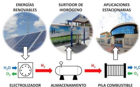
Centrándonos en un sistema de generación, por ejemplo, una instalación fotovoltaica, en ocasiones no se puede evacuar toda la energía eléctrica generada a la red. Es ahí donde entra en juego el almacén de energía, ya que con el excedente de energía que la red eléctrica no es capaz de absorber se alimentaría a un
