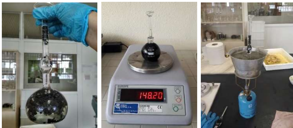
Figura 10. Proceso ensayo peso específico y densidad aparente de las partículas en el laboratorio, muestra S4, pesado muestra S2 y eliminación de burbujas muestra S4.
