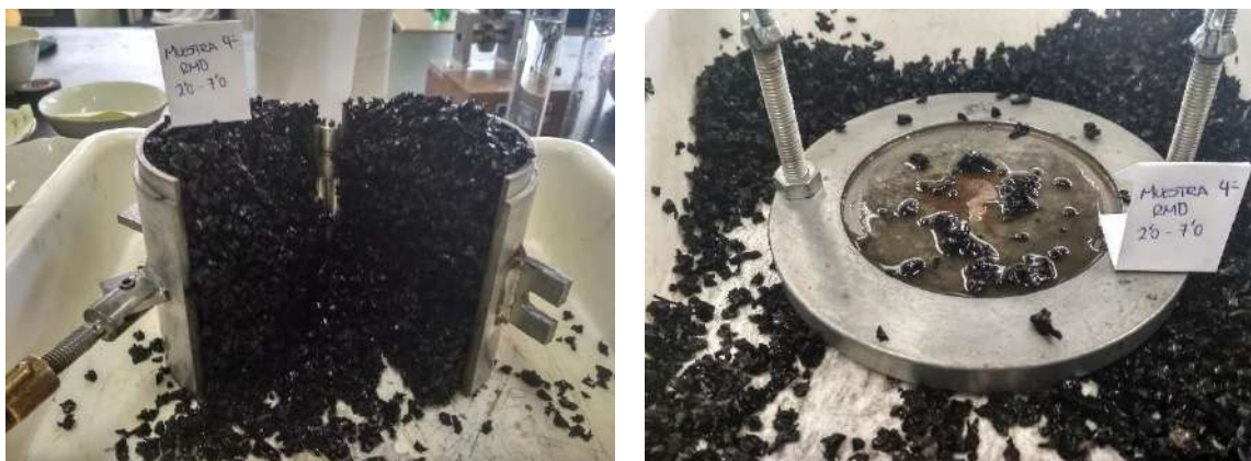
Figura 12. Ensayo de compactación Próctor normal según muestra S4.
