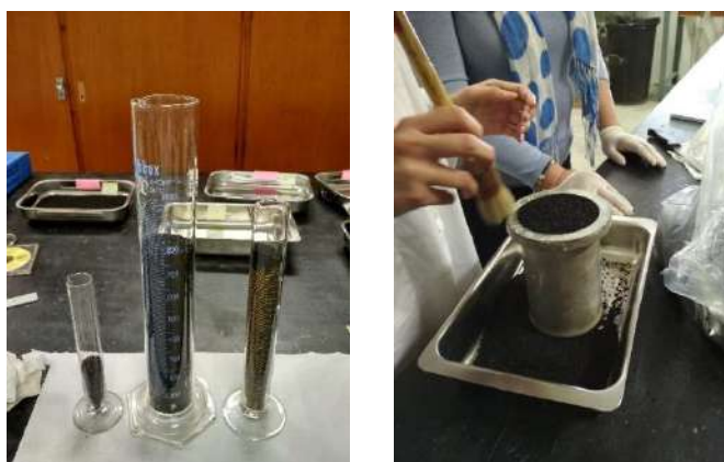
Figura 11. Proceso ensayo densidad aparente del conjunto de las partículas en el laboratorio.
