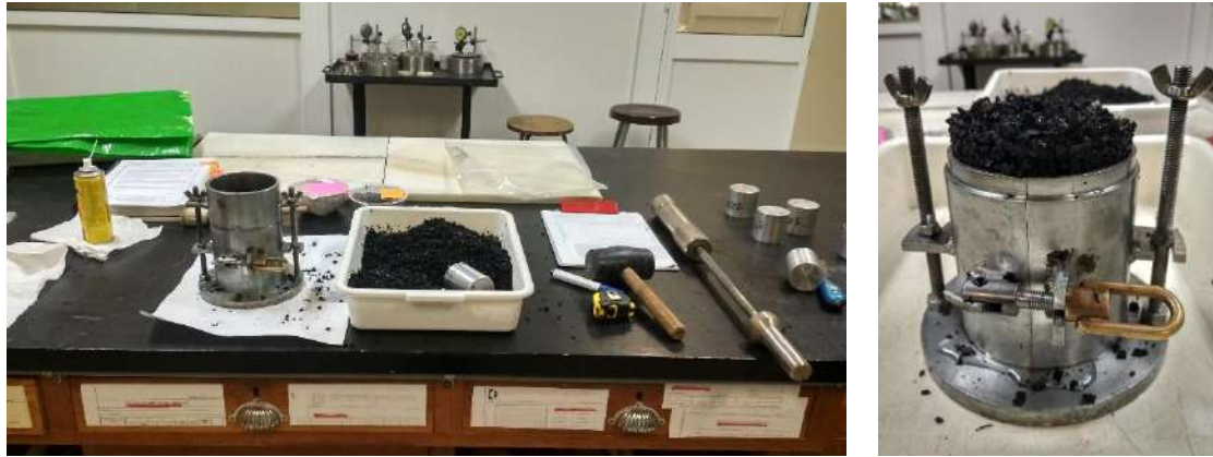
Figura 13. Ensayo de compactación Próctor modificado según muestra S4.
