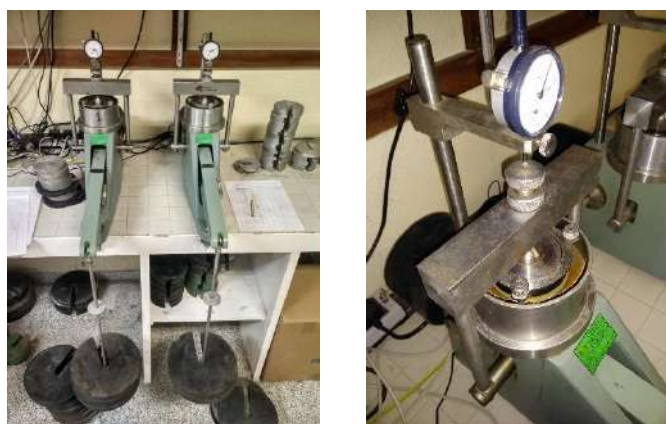
Figura 14. Ensayo de compresibilidad unidimensional según ISO 17892-5:2017
