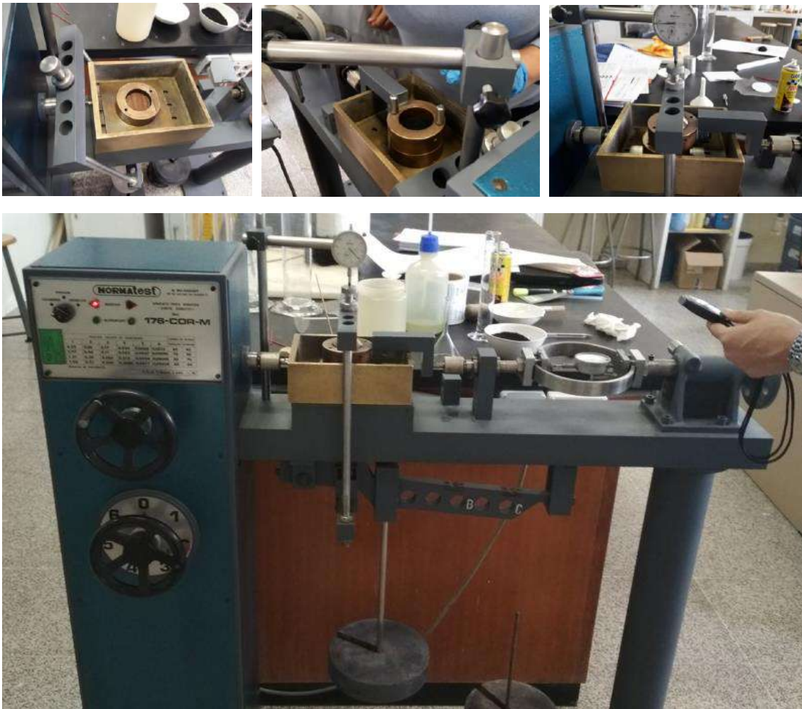
Figura 16. Proceso ensayo corte directo muestra S5.
