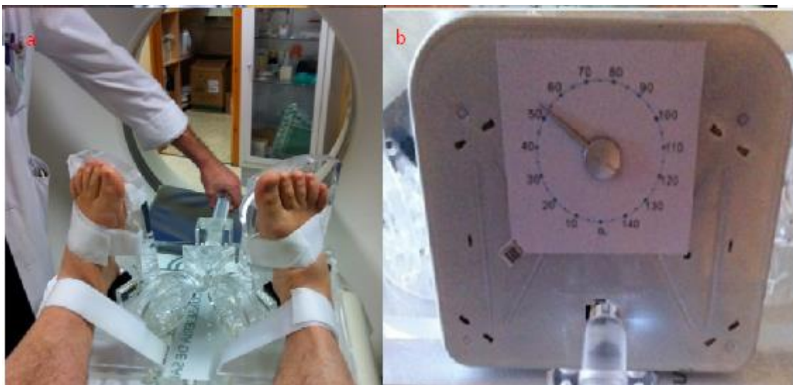
Figura 21. Fotografías del sistema de aplicación y control de la fuerza axial a. Tornillo sin fin aplicando fuerza axial. b. Dinamométrico que permite ajustar la fuerza axial al peso corporal.
