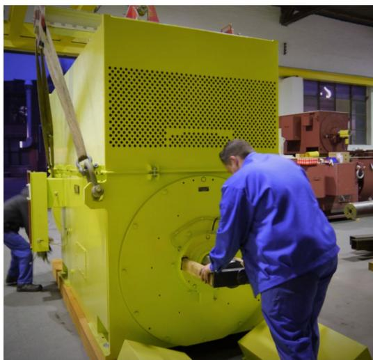
Figura 27. Modelo de motor eléctrico de 11 kV de *Menzel Elektromotoren*. [61]
