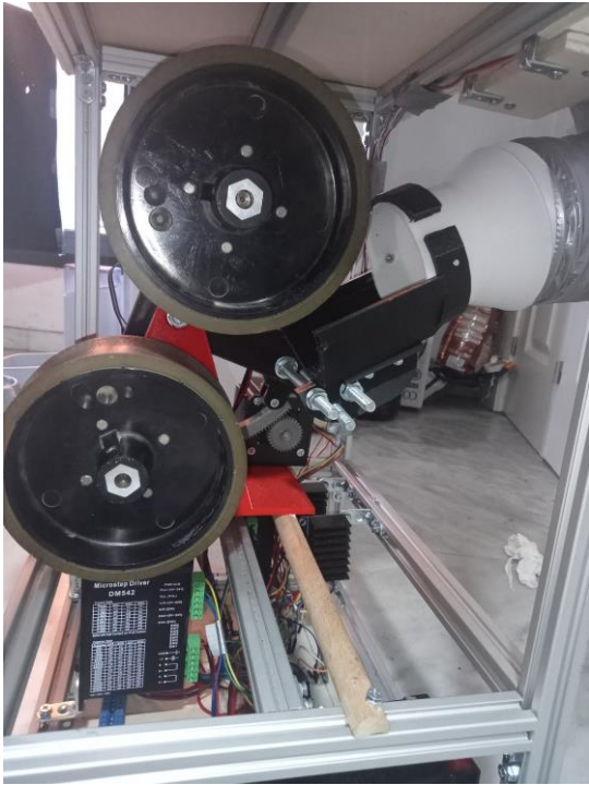
Figura 28. Rodillos y entrada del tubo de alimentación Fuente: Elaboración Propia
