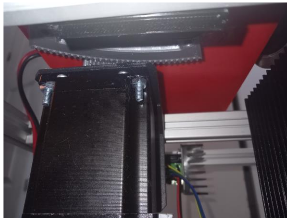
Figura 30. Mecanismo de Ángulo de lanzamiento Horizontal
