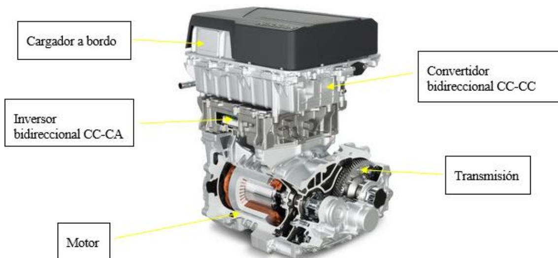
Figura 1-5. Motor eléctrico de un Nissan Leaf [8].
