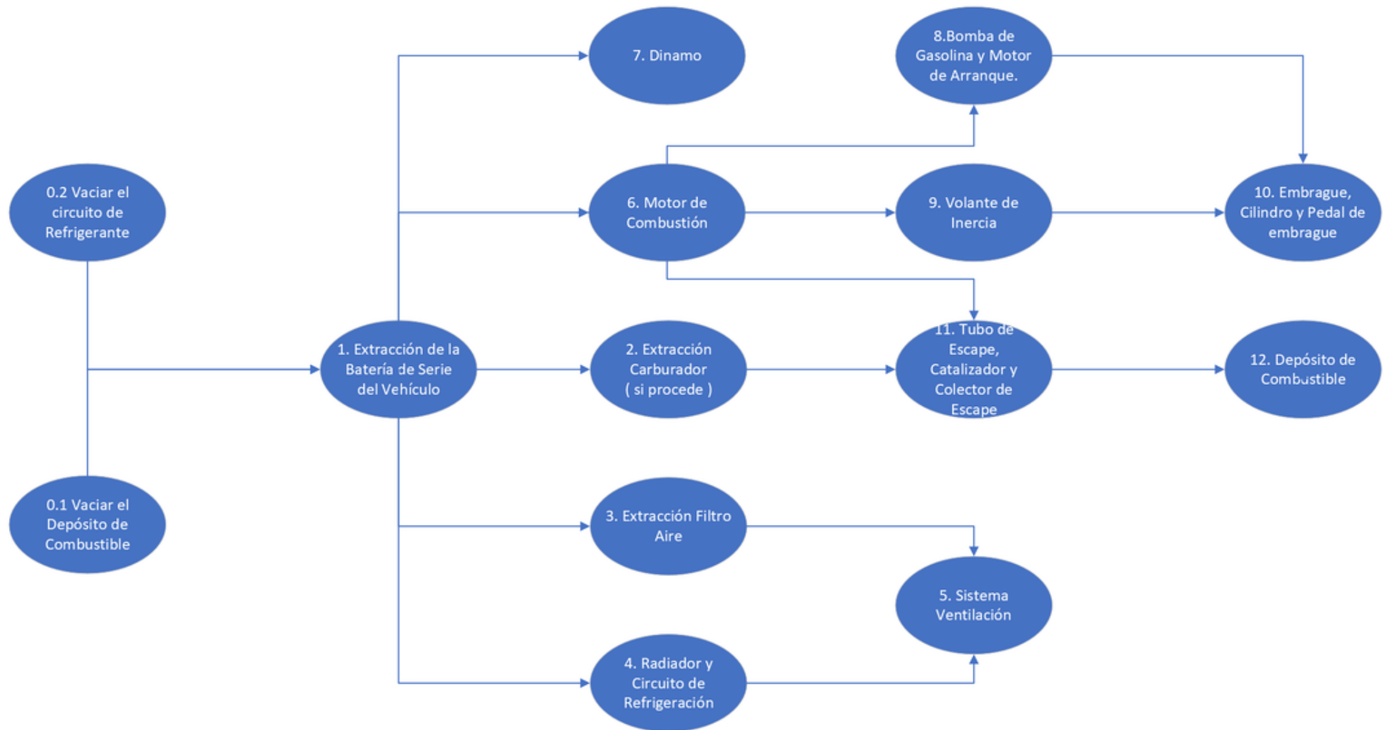
23. Diagrama de Actividades de Desmontaje con relaciones de precedencia.
