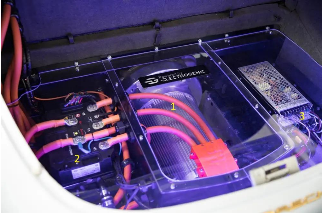
16. Interior de un Porsche GT convertido a EV
