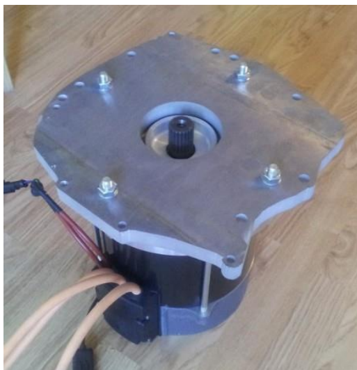
17. Placa Adaptadora instalada en el Motor eléctrico
