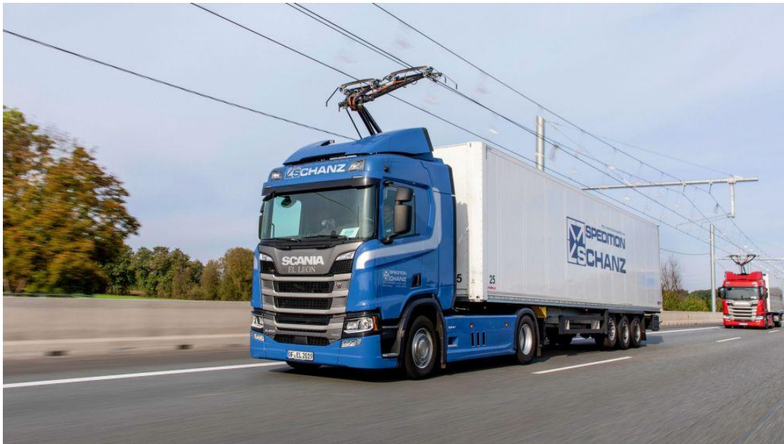
Figura 1-12. Carretera electrificada por un sistema de catenarias, proyecto colaborativo de Siemens y Scania. Fuente: Híbridos y eléctricos
