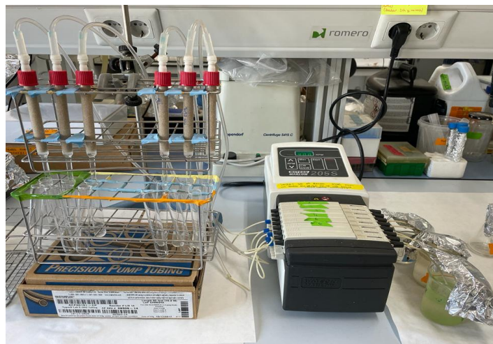
Figura 3.6. Esquema experimental para el estudio del transporte en columnas de percolación.
