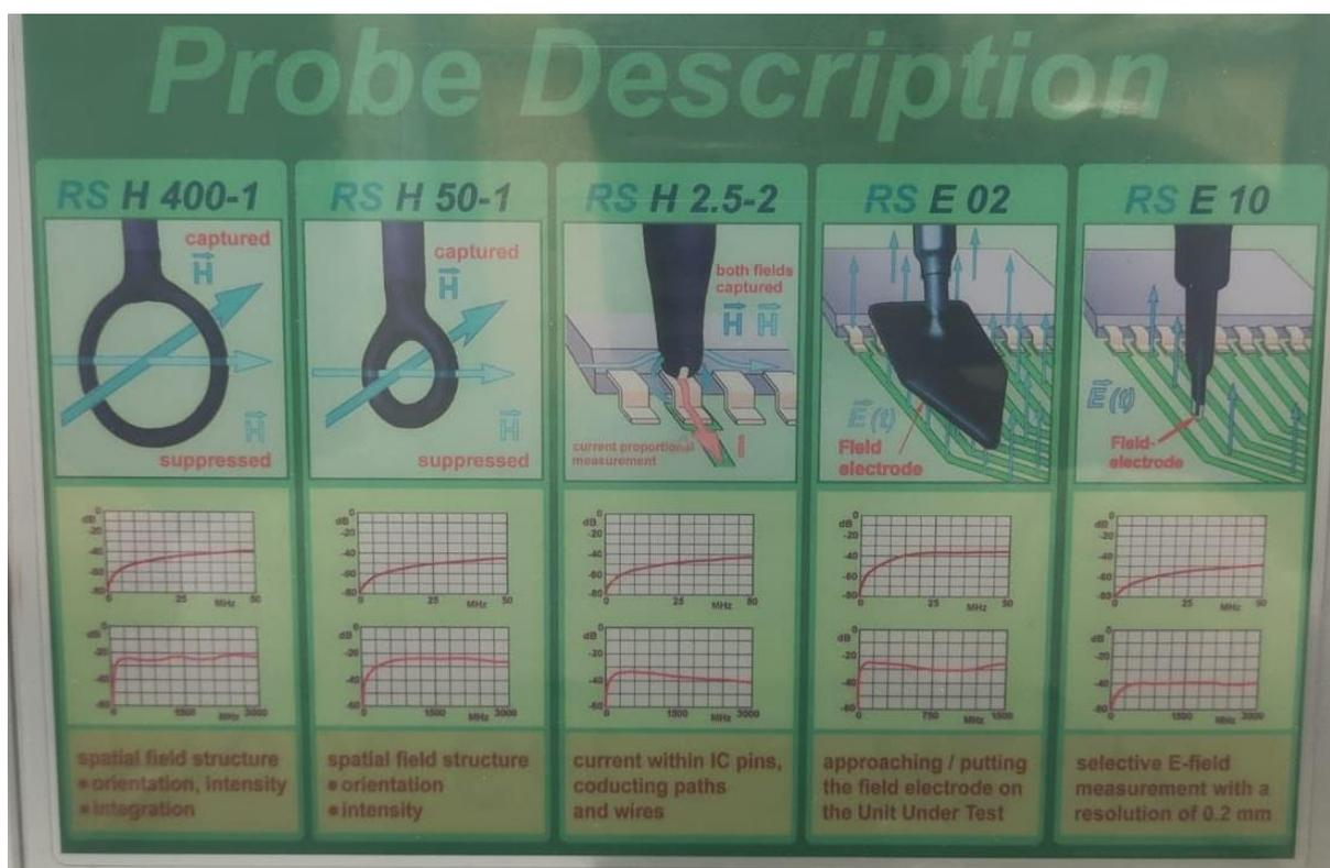
Figura 6. Descripción de las sondas del kit.
