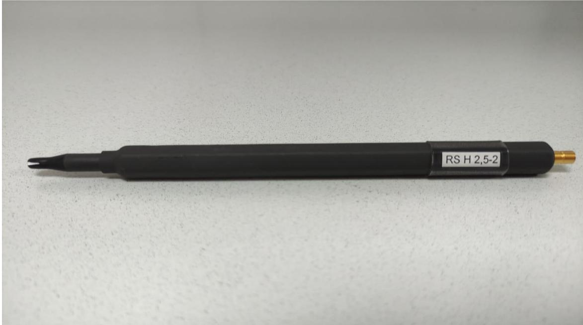
Figura 5. Sonda de medida de campo magnético cercano.
