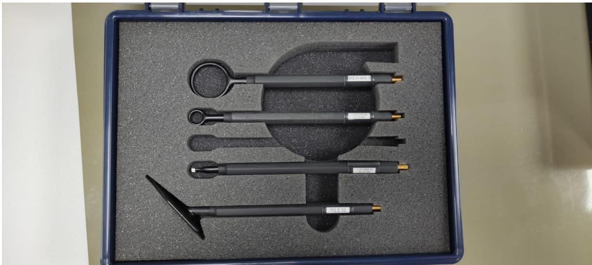
*Figura 4. Kit de sondas de electromagnéticas.*
