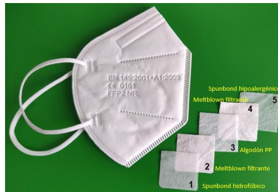
Figura 10. Capas de una mascarilla FFP2 (Rumbo-Prieto, 2021)
