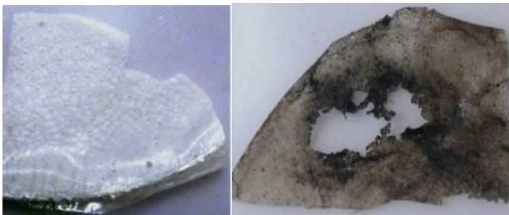
Figura 21. Degradación de un film de PU tipo poliéster producido por Aspergillus tubingensis comprado con una muestra control tras 2 semanas de incubación. Referencia: Khan et al., (2017).
