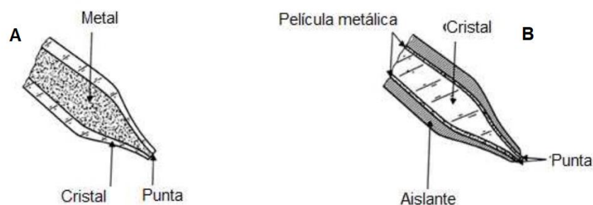
Figura 9: Estructura de electrodos empleados en el registro extracelular unitario. A: electrodo metálico. B: Electrodo de armazón metálico (Sánchez López and Gómez González, 2014).
