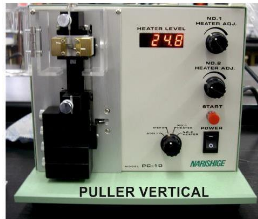
Figura 15: Puller vertical. Instrumento empleado en la preparación de micropipetas (Pardillo Díaz, 2017)
