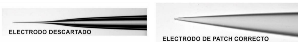
Figura 16: Pipeta correcta. Imagen que establece la diferencia entre la punta de una micropipeta válida para formar parte del electrodo de la técnica y una que debería ser descartada (Modificada de Pardillo Díaz, 2017).
