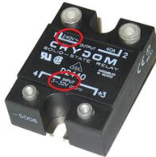
Figura 2-1. Relé de estado sólido (SSS) de 3V a 240V [6]
