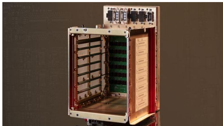
Figura 2-2. Módulo típico de una PDU vacío con conexiones externas [7]
