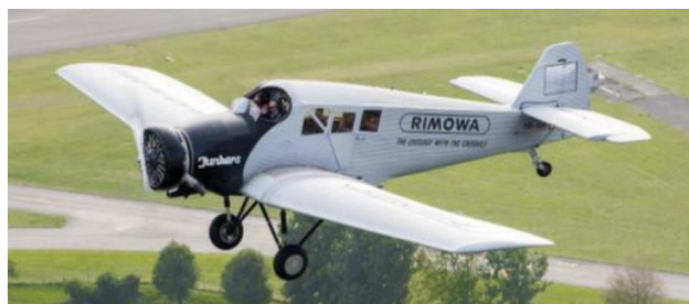
Figura 1-5. Primer avión metálico Junker F13 (1920) [1]
