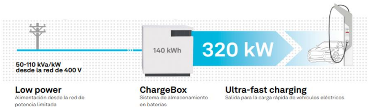
Ilustración 10: Esquema funcionamiento batería
