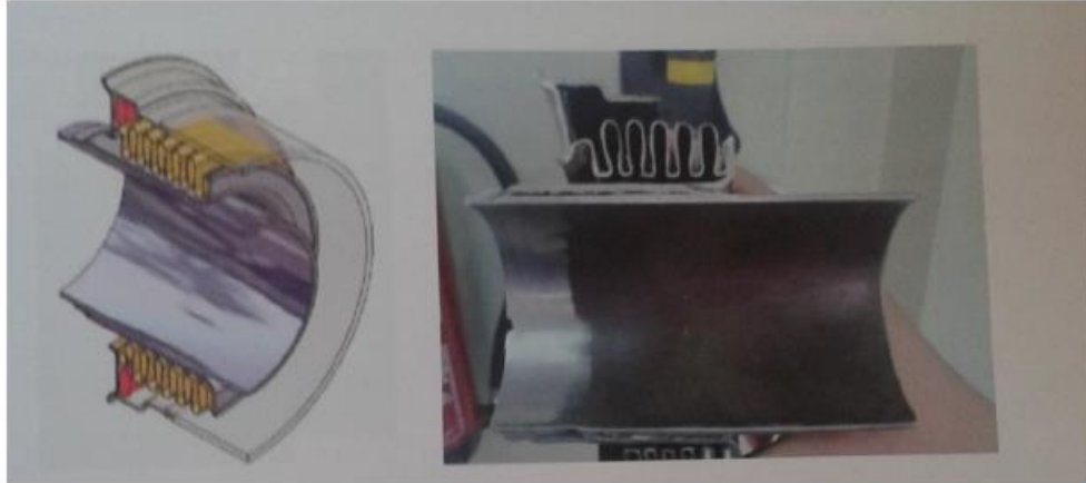
Figura 17.- Corte transversal de un dilatador de un tubo Schott. [4]
