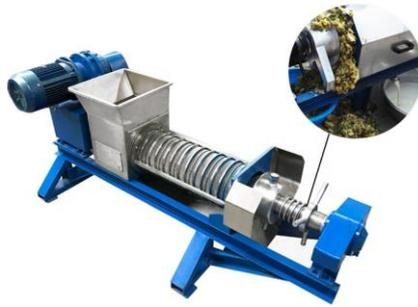
Ilustración 11. Tornillo prensa horizontal
