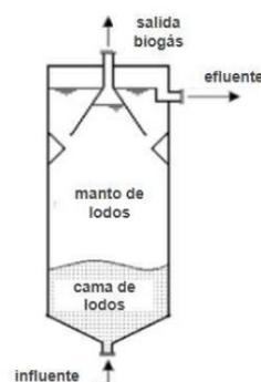
Ilustración 15. Reactor UASB
