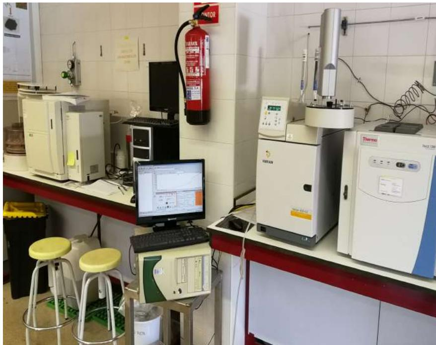
**Figura 27:** Cromatógrafo para medición de VFA.
