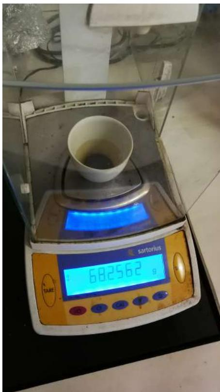
**Figura 26:** Medición de sólidos volátiles suspendidos por diferencia.
