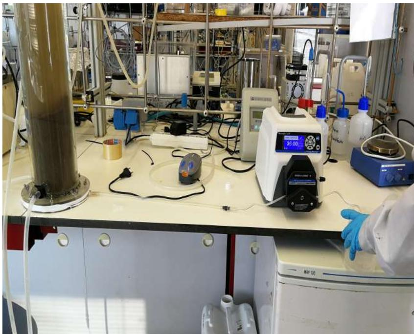
Figura 22: Conexión de bomba con el influente del reactor.
